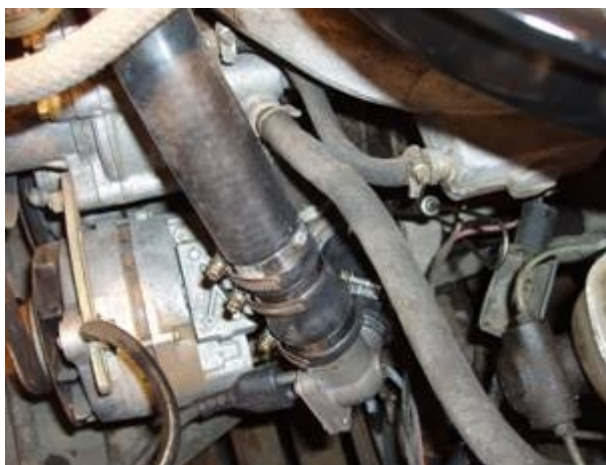
Рисунок 5 Монтаж подогревателя на ИЖ-2126-020
