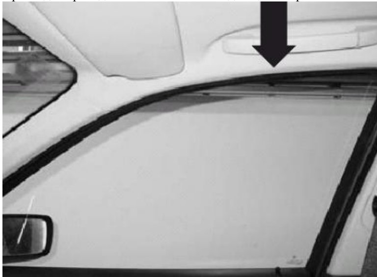
Прокладка провода антенны в стойке под защитной резиной.
