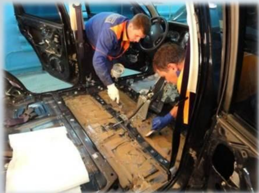
Распределение мастики с помощью шпателей
