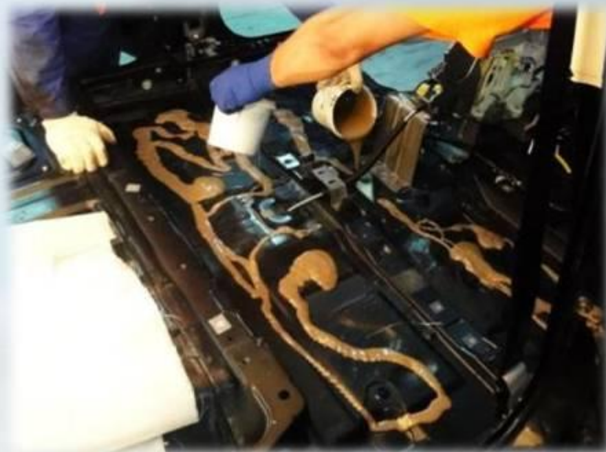
Начало монтажа упрочняющей мастики
