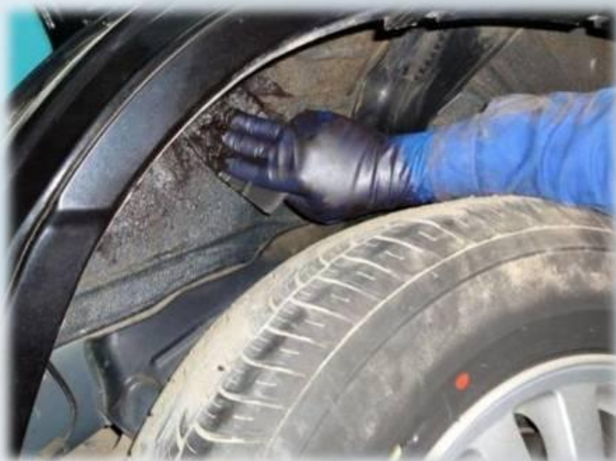
Нанесение и распределение мастики с помощью полиэтиленового шпателя.
