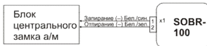
Схема подключения SOBR-100 к контроллеру центрального замка автомобиля
