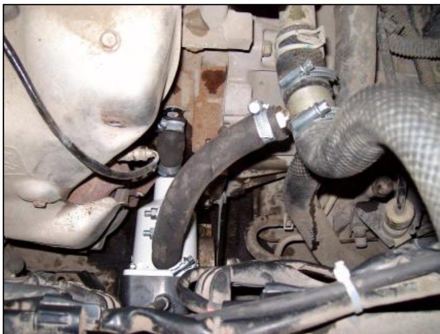
Рис.2. Монтаж штуцера К1/4", тройника Ø28×16, входного и выходного рукава.
