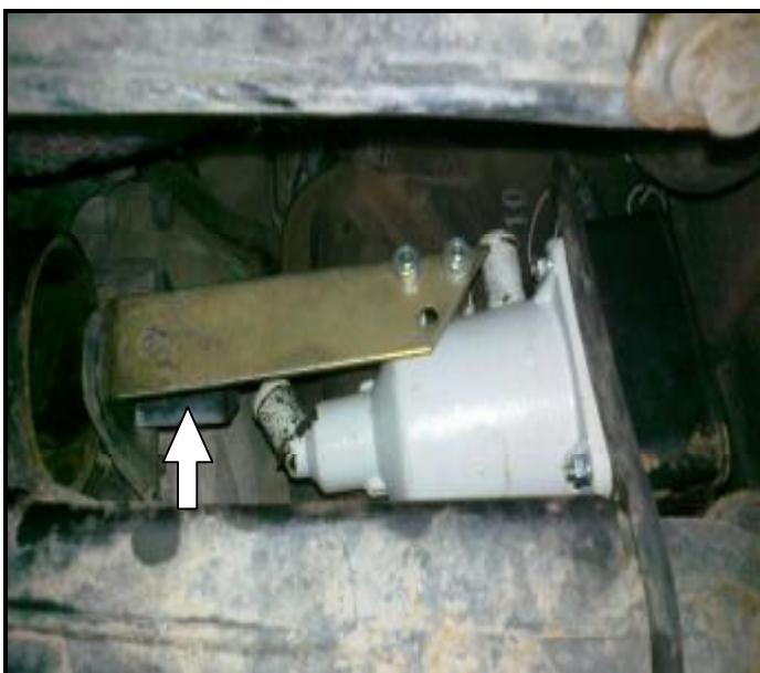
Рис.3 Крепление подогревателя на опоре
