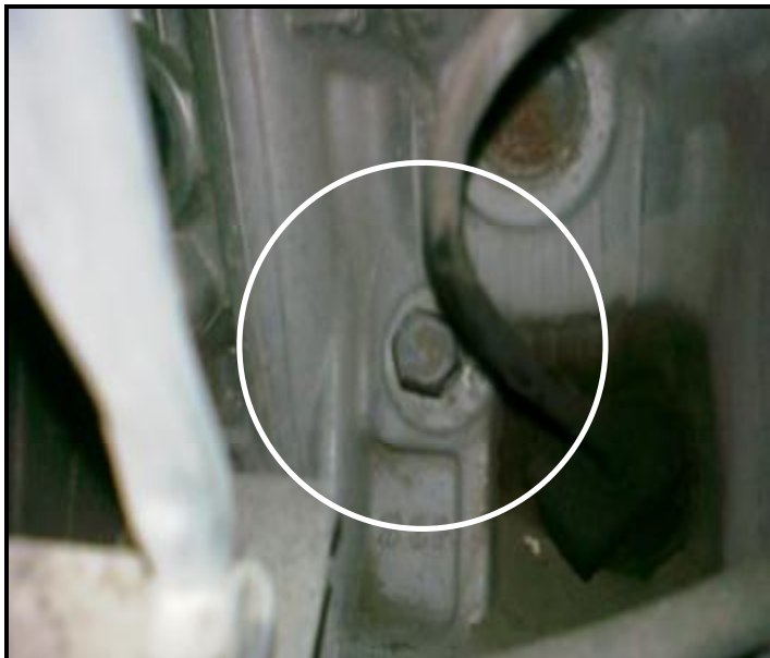
Рис.1 Местоположение сливной пробки
