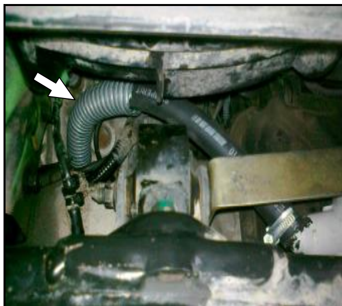
Рис.4 Положение входного рукава и теплозащитный экран
